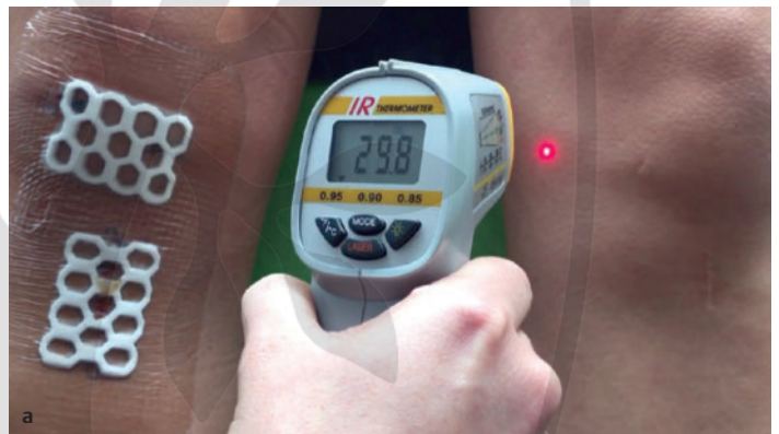
► Abb. 2 Kontaktlose Infrarot-Thermometer sind hervorragend geeignet, um die Hauttemperatur bis auf ein Zehntelgrad genau zu messen. Quelle: © Bild gestellt von DIGOTOR GbR
