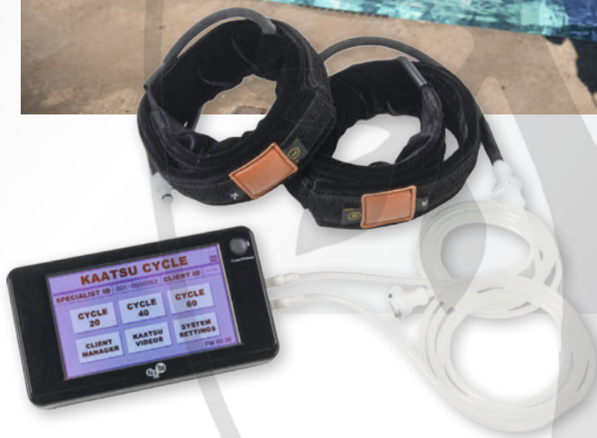
ABB. 2 Apparatives BFRT: Mithilfe spezieller Blutdruckmanschetten misst dieses Gerät den arteriellen Okklusionsdruck. Davon ausgehend wird die punktgenaue Einstellung der Blutflussreduktion entsprechend der Trainingsempfehlungen ermöglicht.
