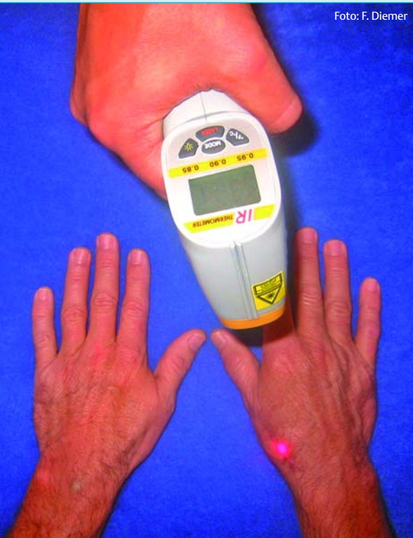
Abb. 4 Für die Messung der Hauttemperatur gibt es unterschiedliche Geräte. Um den Messpunkt genau zu lokalisieren, eignet sich ein Gerät mit Such-Laserpointer.
